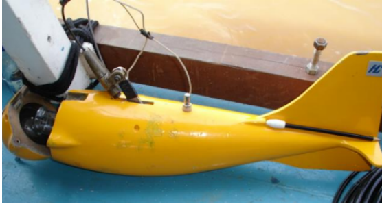
Figure 2.5: Coleta de Sedimentos em Suspensão - Modelo de Amostrador 01
